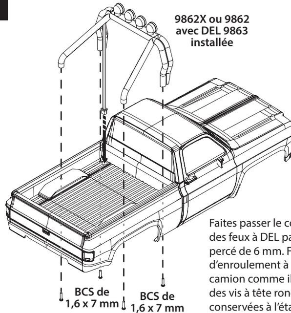
Faites passer le connecteur des feux à DEL par le trou percé de 6 mm. Fixez la barre d'enroulement à la carrosserie du camion comme illustré, à l'aide des vis à tête ronde de 1,6 x 7 mm conservées à l'étape 1.
